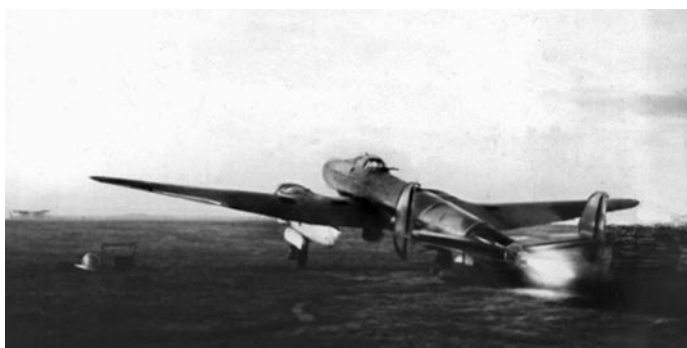
Взлет бомбардировщика Пе-2 с жидкостной ракетной установкой Интернет-выставка «К 100-летию С.П. Королева»
